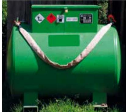
Die „Behälter“ müssen so konstruiert sein, dass ein Freiwerden vom Inhalt verhindert wird.
