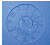
Beispiel Herstellungszeichen Kunststoffverpackung Gefahrgut
